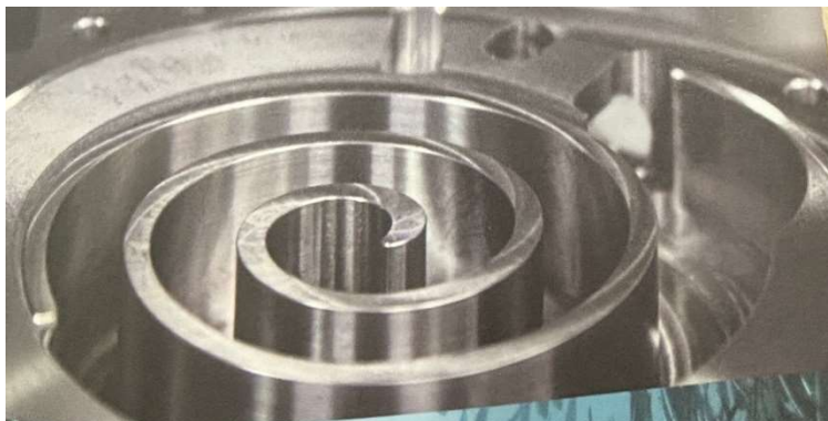
写真3 スクロール圧縮機の圧縮機構(渦巻)部分
