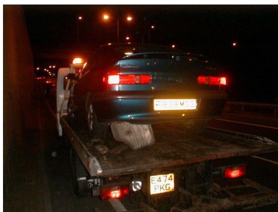
レッカー上の車、マフラーが脱落している
