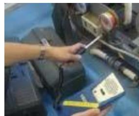
電子式の検知機を用いて、配管等から漏れるフロンを検知する方法。検知機の精度によるが、他方法に比べて微量の漏えいでも検知が可能。
